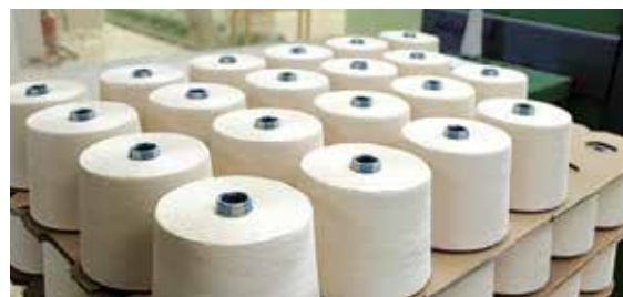
Das Endprodukt, welches die Firma verlässt, ist eine Spule von rund 1,5 kg Gewicht, die etwa 200 Kilometer Garn trägt.
