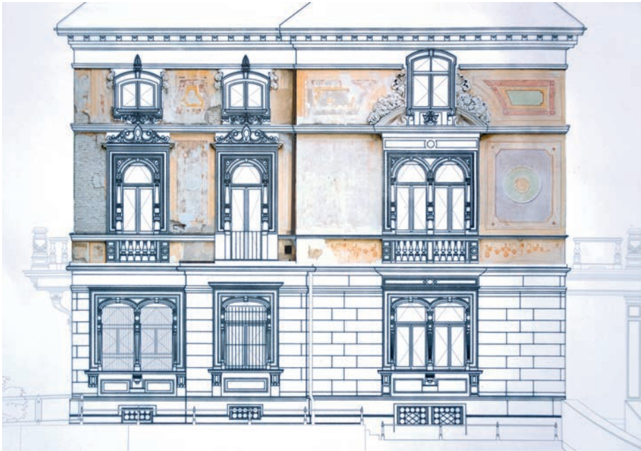
Links: Auf Plänen des Malereibestands und Vorzustandsaufnahmen wurden Umfang und Intensität der Retuschearbeiten erprobt (Fassadenabschnitt am rechten Rand). Unten links: 1:1-Pausen auf Melinexfolien zur Übertragung und Ergänzung der Ornamentik. Aufnahme Mai 2012. Unten rechts: Vor allem die Ornamentik des Mezzaningeschosses wurde mittels 1:1-Pausen und Kartonschablonen übertragen. Aufnahme Mai 2013. ARGE Konservierung/Restaurierung Fassaden Villa Patumbah 2013 (wie Anm. 28), S. 120–122.
