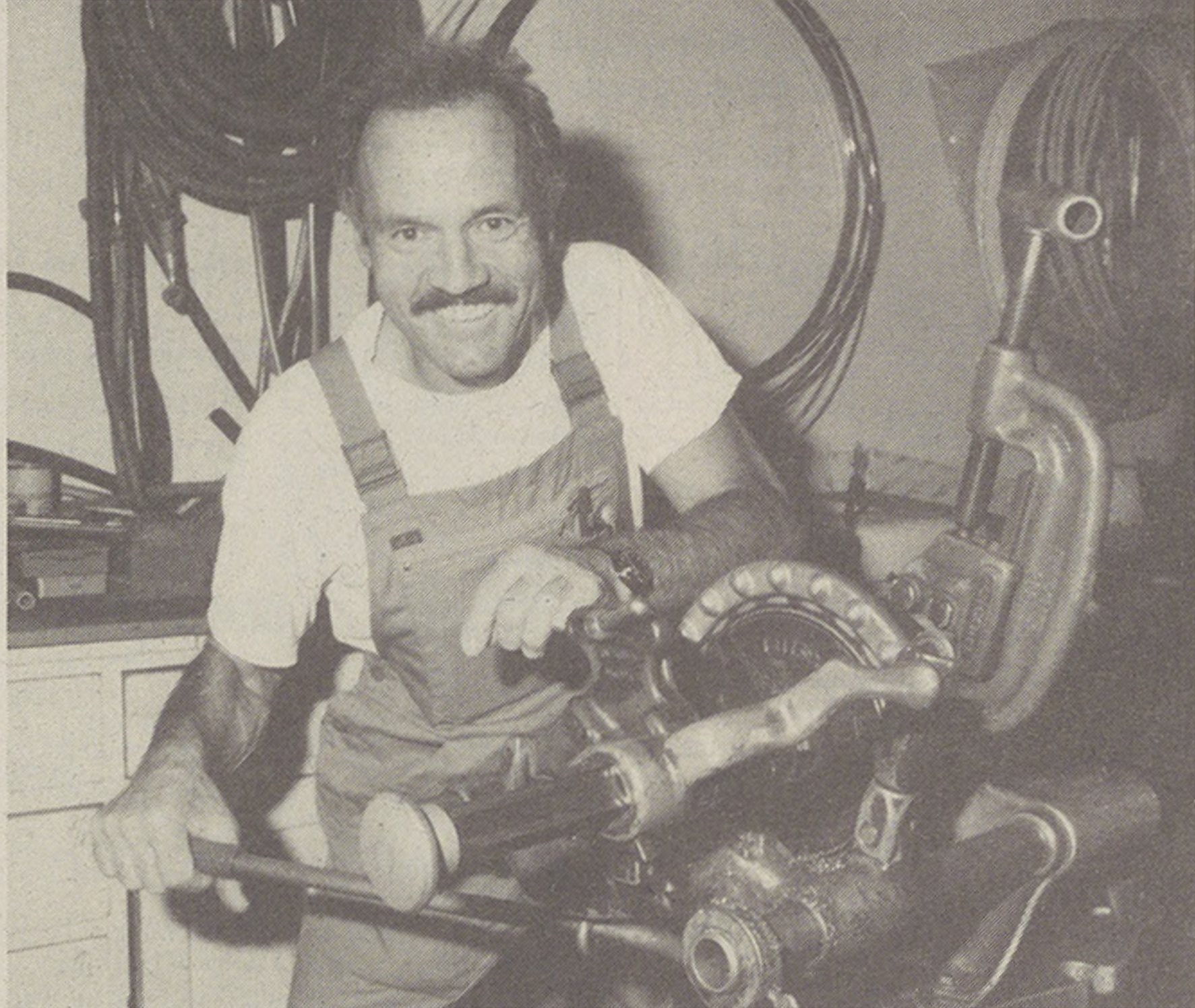
Ein kleines mechanisches Wunderwerk, die Gewindeschneidemaschine... die Bedienung kein Problem für Norbert Caplazi!
