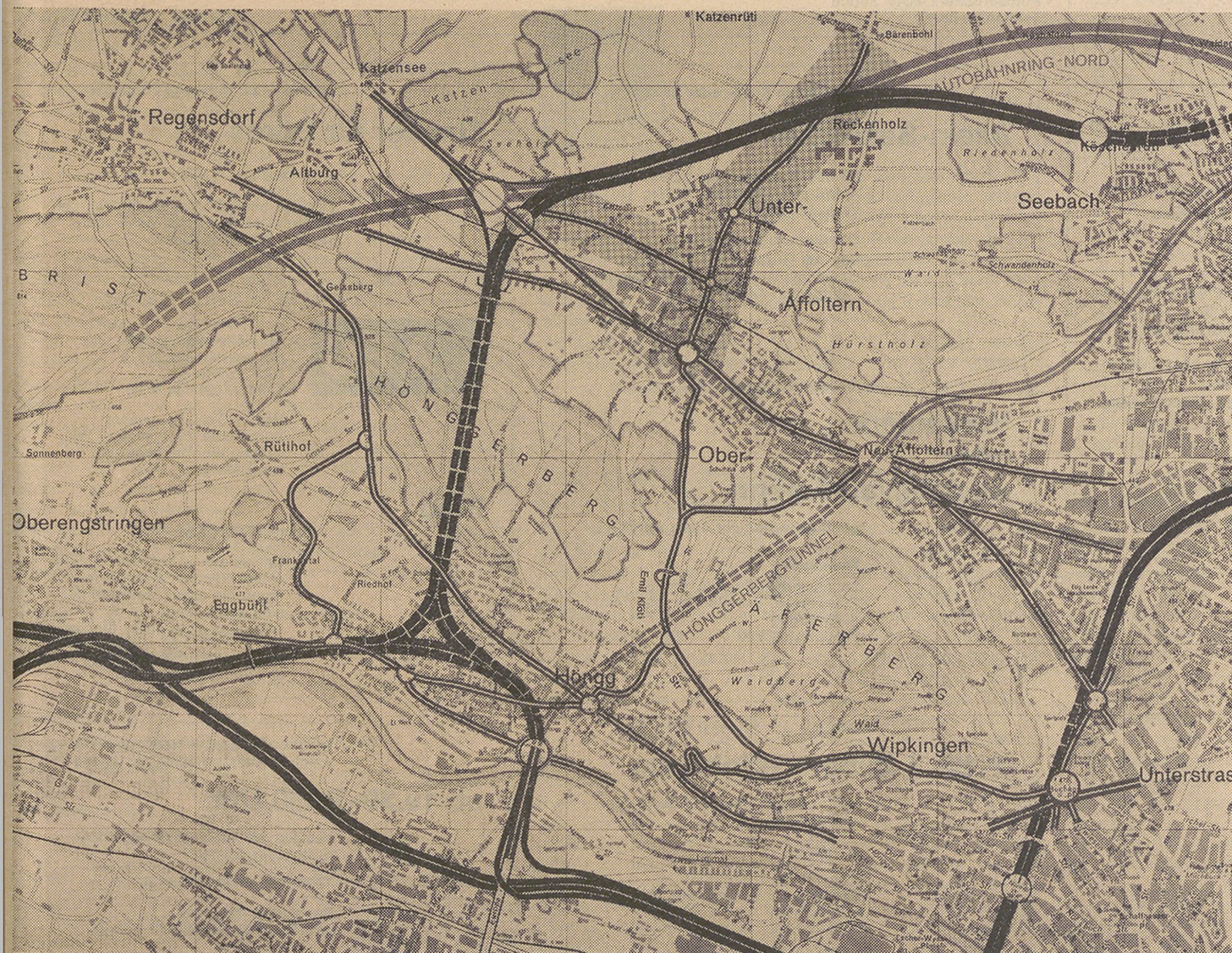
Die vorgeschlagene Führung des Hönggerberg-tunnels
