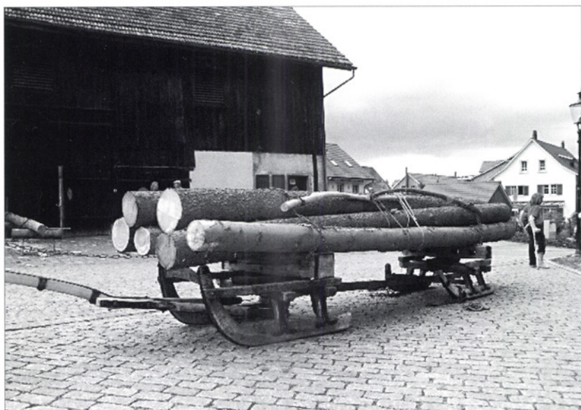
Holzfuhr am Mühletag 2003 in Maur. Der Holzschlitten stammt aus der ortsgeschichtlichen Sammlung Maur. Mittels einer «Langwid» wurden zwei Einzelschlitten je nach Länge der Stämme zusammengehängt.
