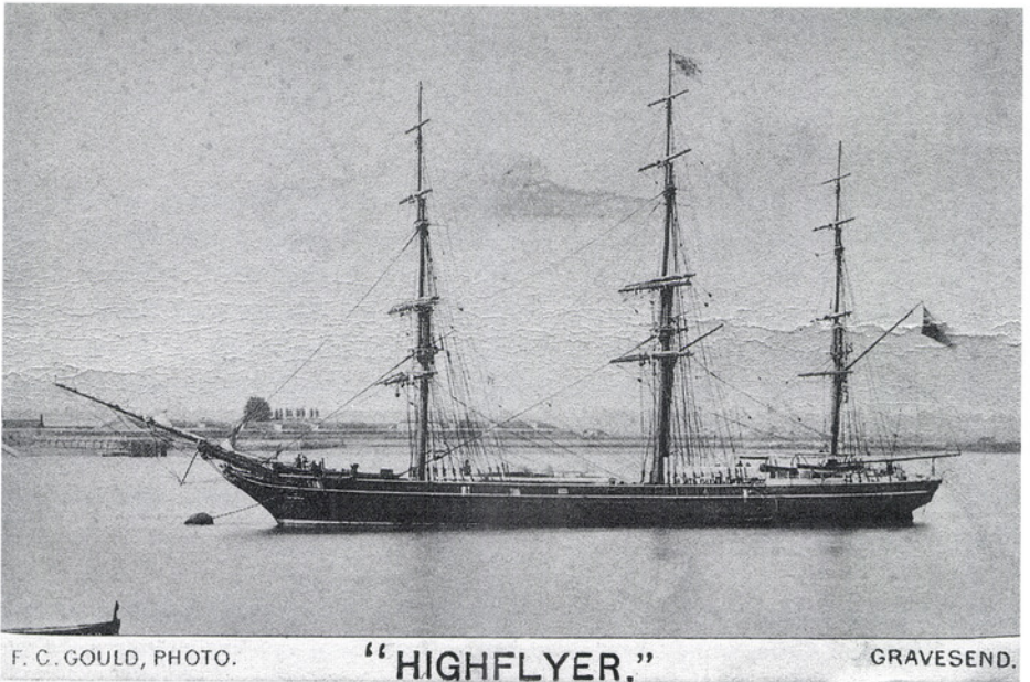
Die «Highflyer», ein 3-Mast-Rahsegler, vorne Klüverbaum über dem typisch s-förmig geschwungenen Bug.
