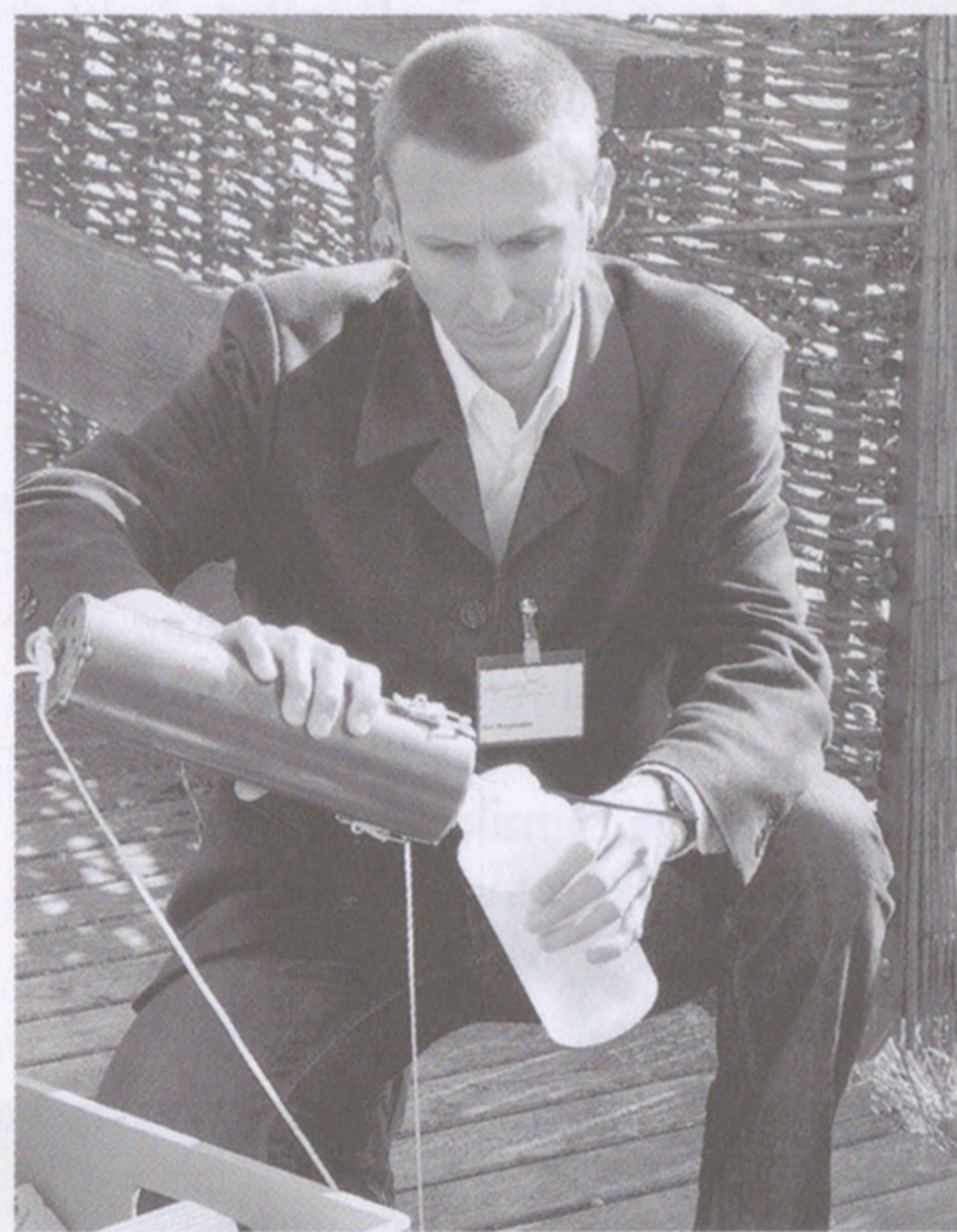
Auswerten in der freien Natur: Urs Wegmann von der Greifensee-Stiftung giesst für das mobile Labor eine Wasserentnahme ab.
