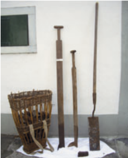
Abb. 5: Ausrüstung für den Torfabbau: Das spatenartig verbreiterte «Turpeschit» zum Abstechen der Torfstücke und der Stiel mit dem Winkeleisen für das genaue Schneiden ihrer Ecken. Der Stiel der Werkzeuge war umso länger, je tiefer unten der Torf gestochen wurde. Der Korb war Transportmittel und ein Mass für den getrockneten Torf. Sammlung Museum am Pfäffikersee, Pfäffikon. Photo M. Fritz, S. 9. 2010
