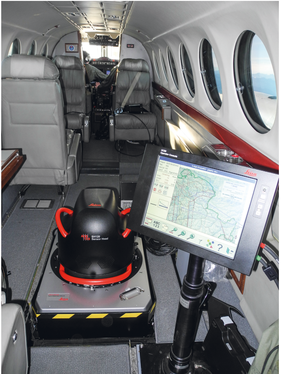
Die ADS100 Kamera ist mit einer kreiselstabilisierten Aufhängung in den Boden der King Air montiert. Weiter vorne befinden sich einige Passagiersitze und das Cockpit des Piloten und des Bordmechanikers.
