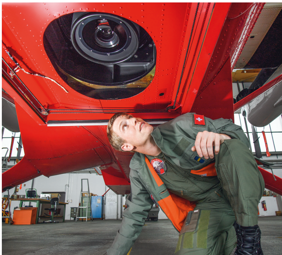
Die komplexe Linse der ADS100 Kamera richtet sich durch die Luke senkrecht nach unten (zum Nadir). Michael Heid überprüft vor dem Start das System.
