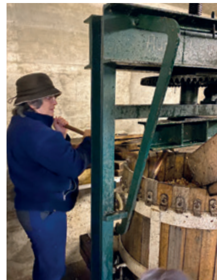
Elisabeth Wyss verteilt die zerkleinerten Apfelstücke vor dem Pressen in der Räder-Joch-Pressen der Marke Bucher-Guyer von 1931
