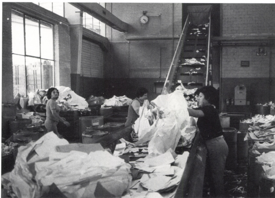
Gastarbeiterinnen sortieren Papierabfälle. Dadurch wird das Verkaufsprodukt hochwertiger.
