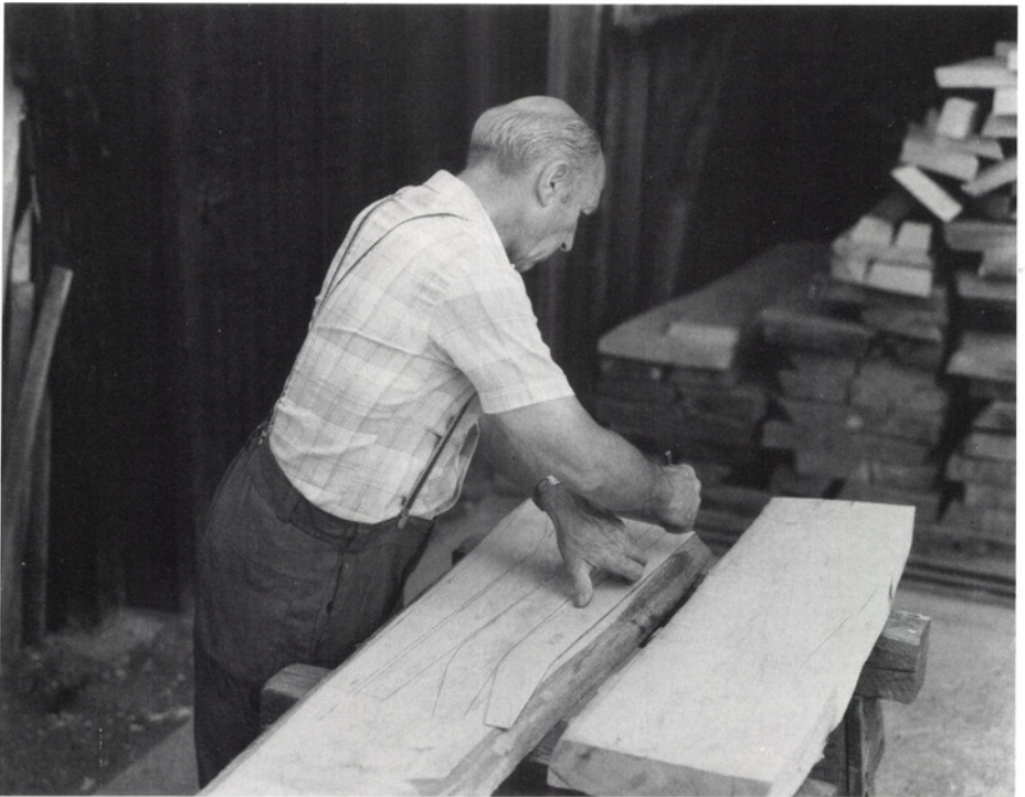
Der Sitzmöbelschreinermeister überträgt die Form auf das Werkstück.
