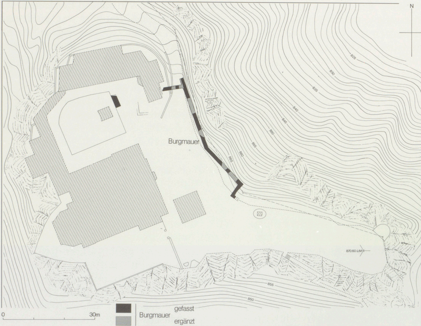
Üetliburg. Plan der Bauten auf dem Uto-Kulm. Schraffiert. Moderne Gebäude; schwarz: Ringmauer aus dem frühen 13. Jahrhundert.
