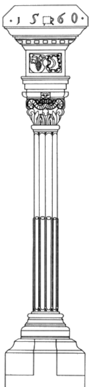
Niederdorfstrasse 3. Fenstersäule von 1560 im zweiten Stock. \frac{1}{10} natürlicher Grösse.
