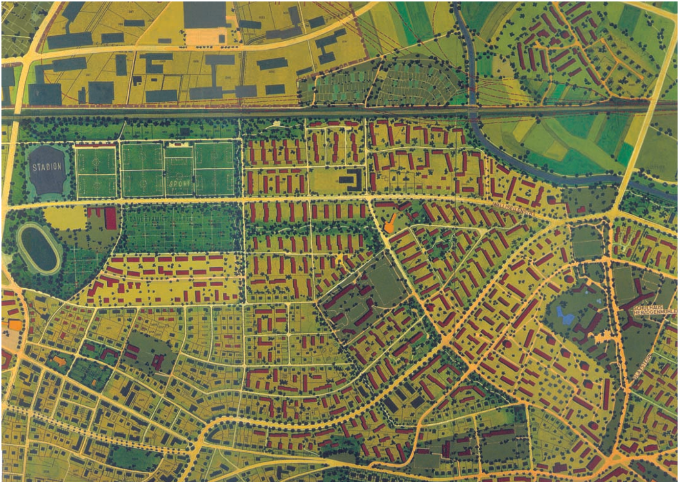
Quartierbebauungsplan von Zürich-Schwanendingen von 1948, Mst. 1:2500 (verkleinert). Bestehende Bauten (grau), geplante Bauten (rot), Grünzüge. BAZ 51 861.
