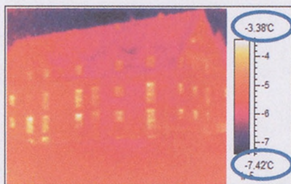
Minergie bei -10°C Aussentemperatur Temperaturumfang Aussenhülle: 4°C
