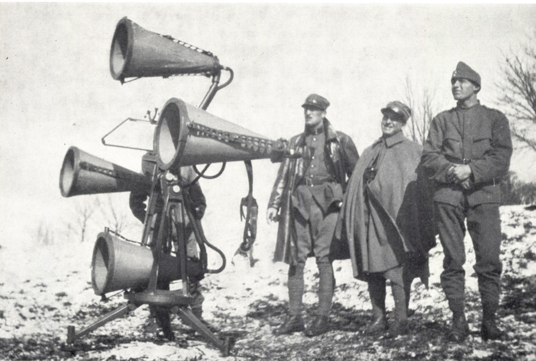
Die Alarm- und Auswertezentralen sind noch auf einfache Hilfsmittel der vorelektronischen Zeit angewiesen: Horchgeräte fangen verdächtige Motorengeräusche am Nordhimmel ab, verstärken kaum Hörbares und registrieren die Richtung. Ein umständliches Verfahren; der Computer ist noch nicht erfunden! (Aufnahme Guy Maeder)
