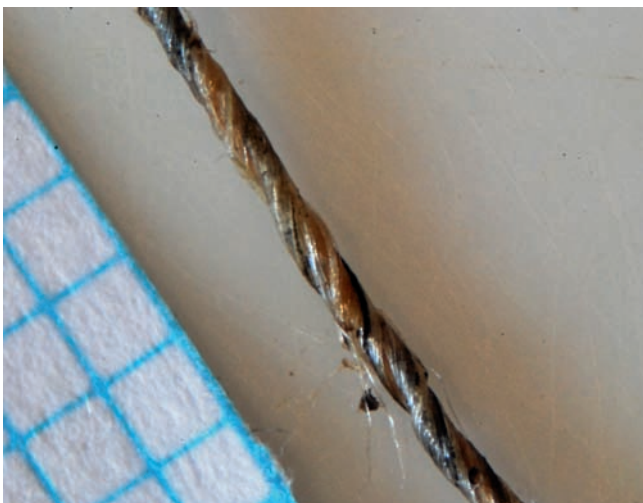
Abb. 70. Makroaufnahme des Fadens mit gerösteten und gespleissten Fasern.
