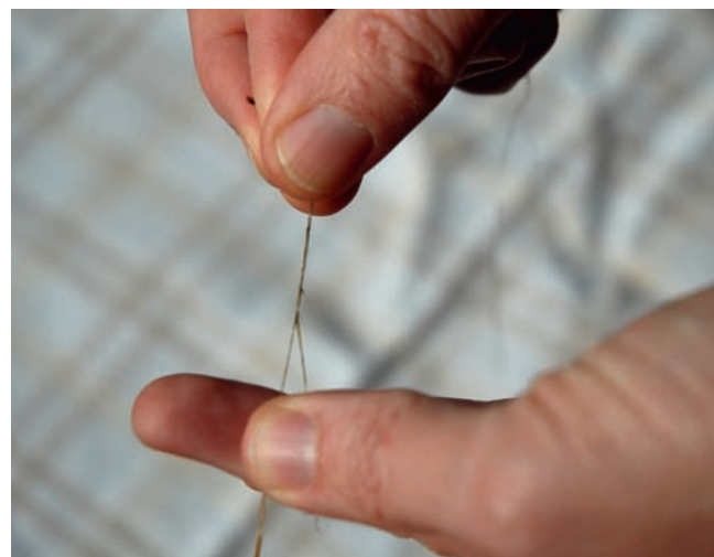
Abb. 68. Spleissen der Faserbahnen-Enden mit Daumen und Zeigefinger.
