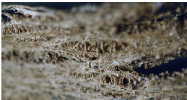
Abb. 37. Lindenbast, konserviert, kollabierte Markstrahlen sind an dieser Stelle noch erkennbar.
