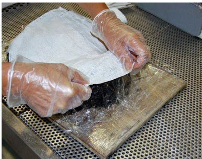
Abb. 8. Anfertigung der Stützform mit nassen Gipsbinden.
