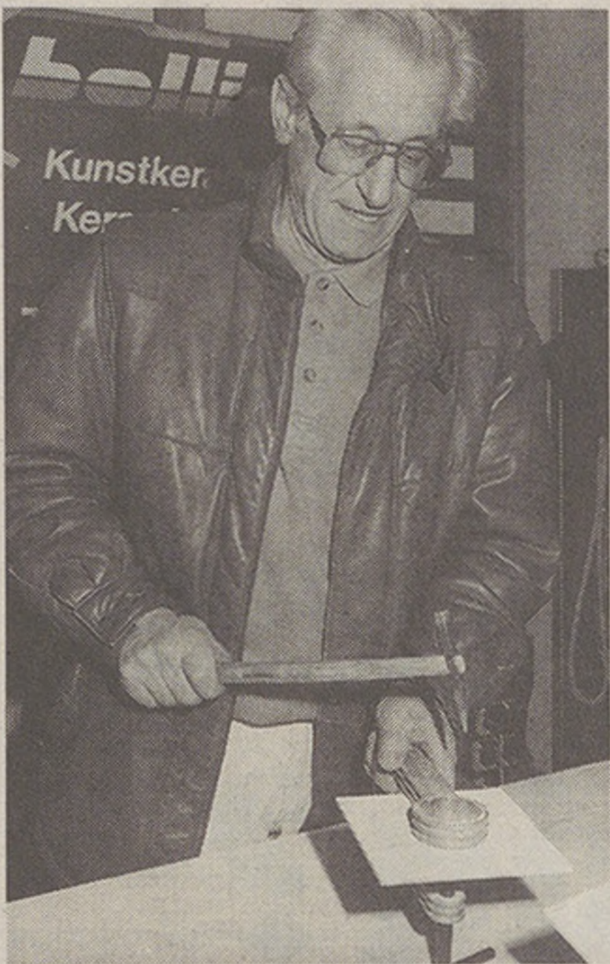
Bartholome Berther, Plattenleger der Firma Bolliger – André Bolliger ist Präsident vom Handel & Gewerbe Höngg – erklärt und demonstriert wie man ein Loch in eine Keramikplatte «schlägt».
