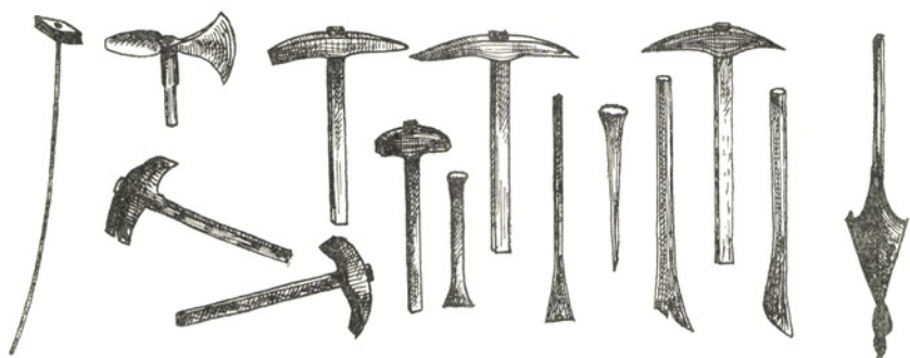
Werkzeuge zum Steinsprengen und zur Bearbeitung der Werkstücke : eiserner Schlägel zum Zerkleinern der grösseren Steine, Mauerhammer, Spitzhammer, Schneidebaue, Hand- schlägel, Keile, Meissel, Stemmeisen, Erdbobrer.
