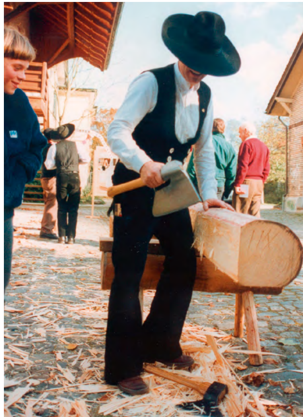
Zimmermann bei der Arbeit mit dem Breitbeil rechts.
