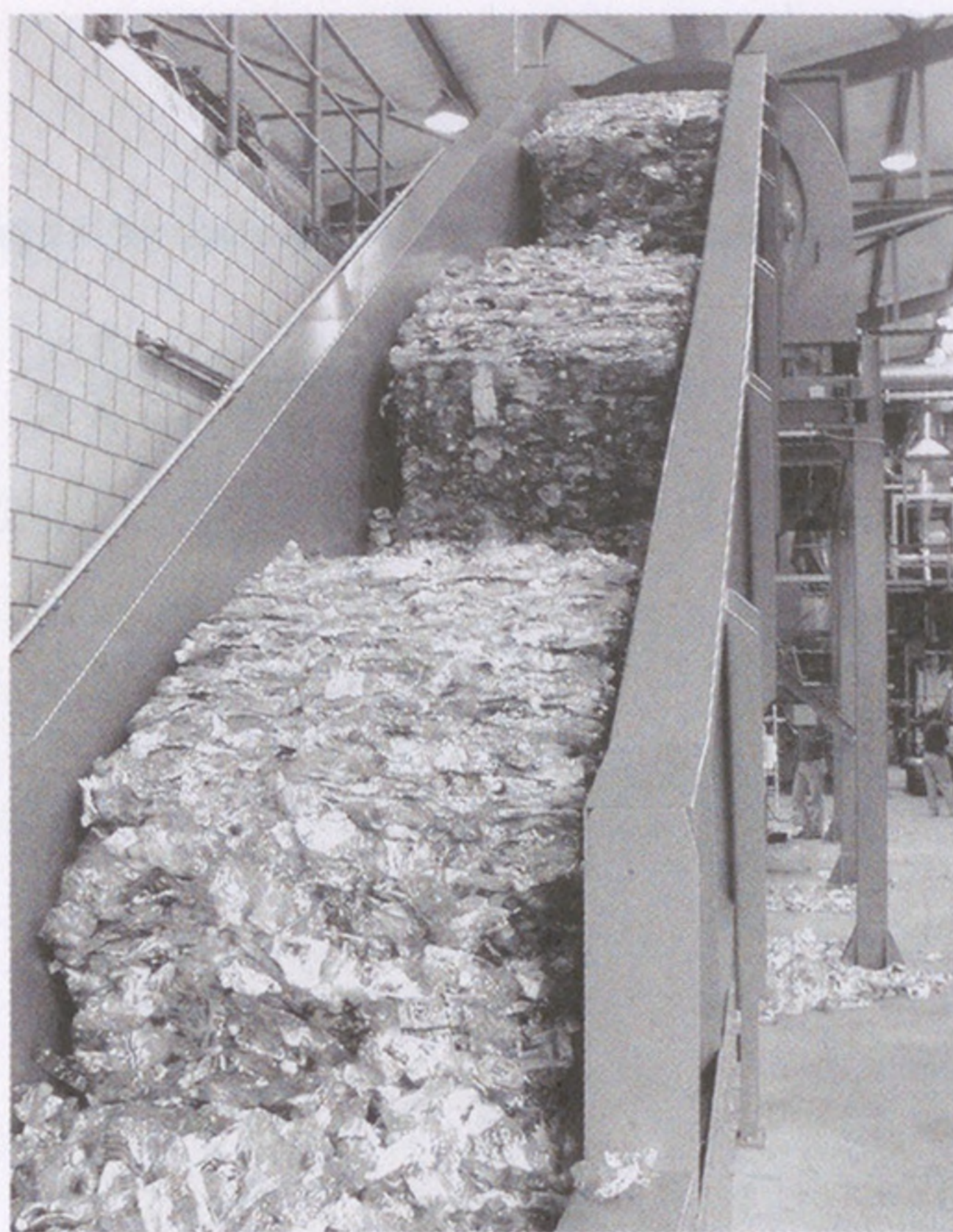
Die modernste und leistungsfähigste PET-Flaschensortieranlage Europas wurde 2005 in Frauenfeld eingeweiht. Pro Stunde werden dort bis zu 140 000 PET-Getränkeflaschen verarbeitet. (Foto: zvg)
