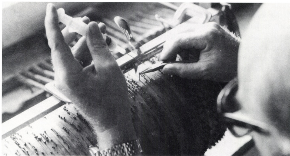
Der Dübendorfer Drehorgelmann befestigt die Drahtstifte einer Stiftenwalze neu
