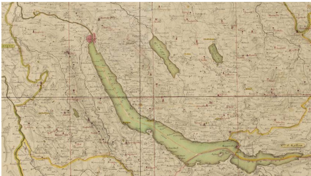
Aus den Anfängen der kantonalen Vermessung: Auf der Kantonskarte von Heinrich Keller aus dem Jahr 1839 sind die bis am 1. November 1843 aufgestellten Vermessungszeichen eingetragen. Pyramiden markieren die Triangulationspunkte z.B. auf der Forch und dem Pfannenstiel. Als weitere Fixpunkte benutzte man «Stangen mit Querbrett» und markante Geländepunkte wie Einzelbäume und Kirchturmspitzen. (Staatsarchiv des Kantons Zürich)
