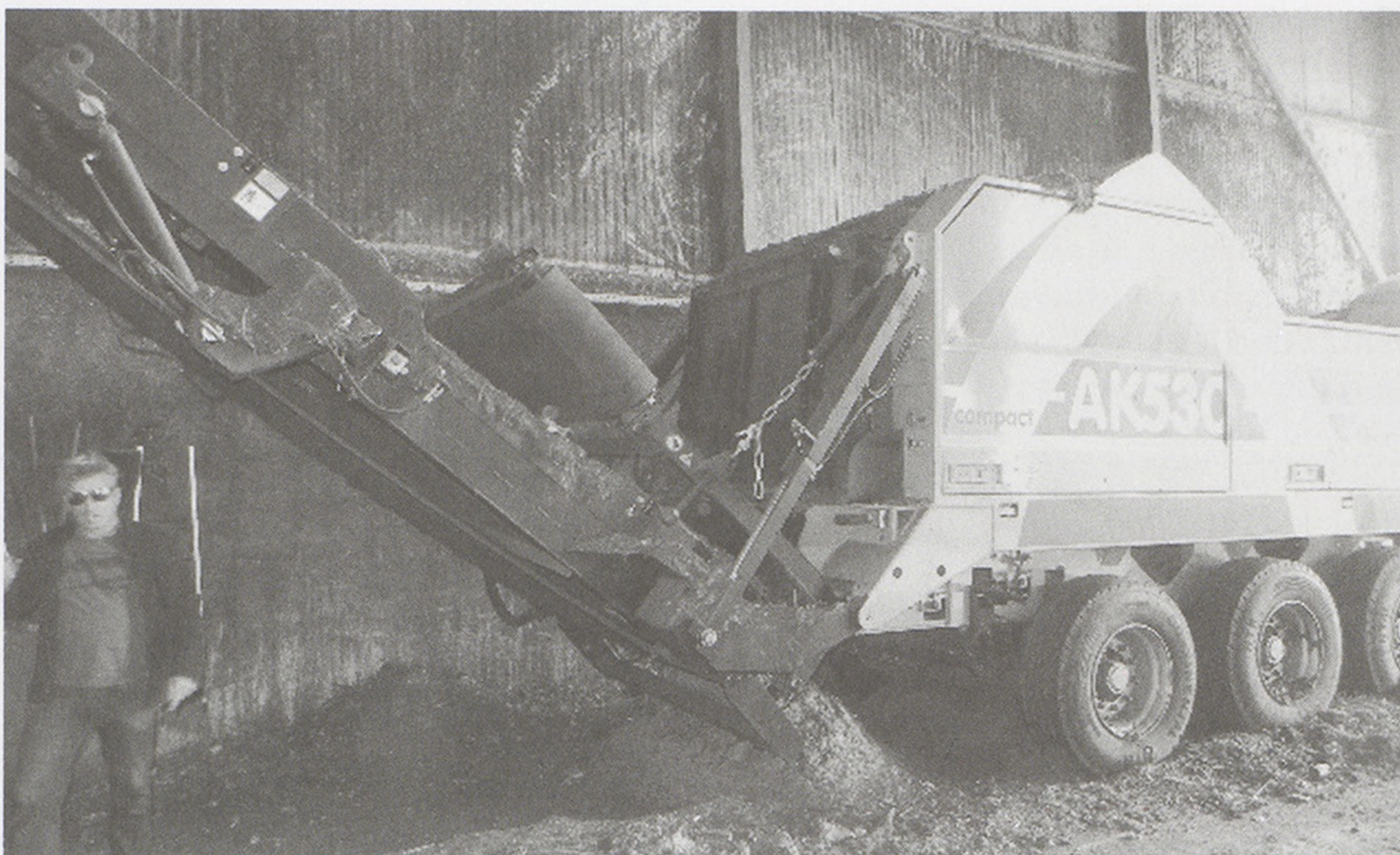
Der Prozess beginnt mit dem Schreddern des angelieferten Grüngutes...
