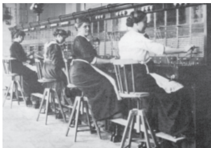
Telefonverbindungen wurden früher noch von Hand vermittelt. Die Zentrale Winterthur um 1890; Bild Fernmeldekreisdirektion
