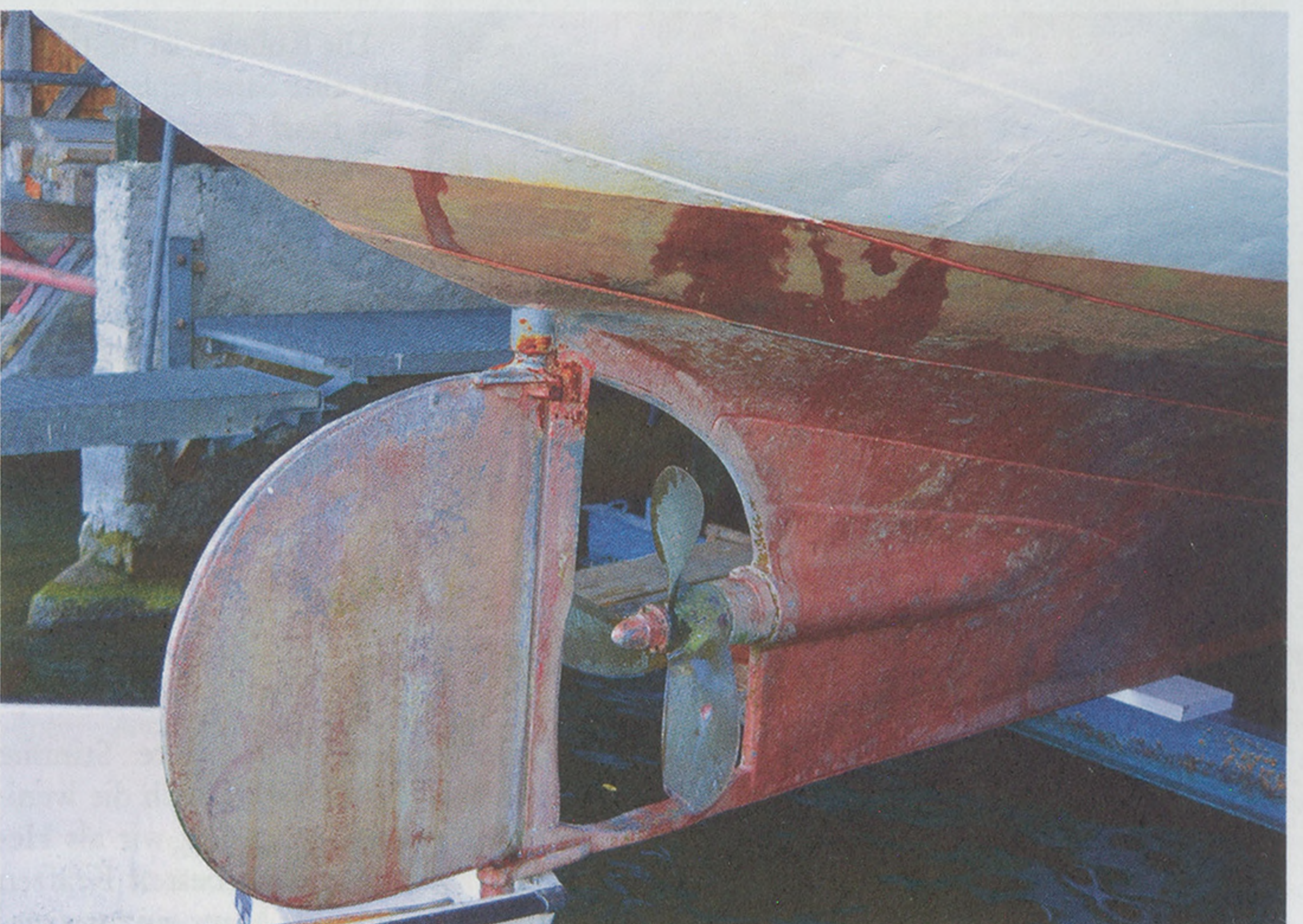
Ruder und Propeller des Motorschiffes «Heimat» – zur Überholung in der Werft in Maur. Der Propeller musste ersetzt werden, weil er durch die Seegrörni arg beschädigt wurde. (Foto: sl)
