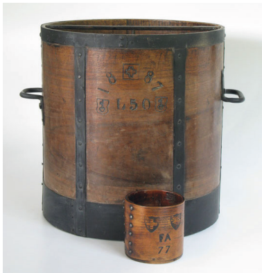
50 Liter Getreidemass aus dem Kanton Obwalden 1887. Höhe: 44 cm, Durchmesser 42 cm und 1 Liter Mass aus dem Kanton Bern 1877. Höhe 12 cm, Durchmesser 12 cm. (waage-mass-gewicht.ch)
