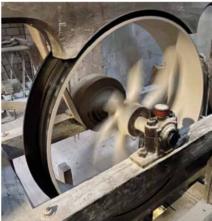
Ohne Rad und Räder geht in der Mühle Heitertal nichts. Sie übertragen die Kraft vom Elektromotor zu den Maschinen.
