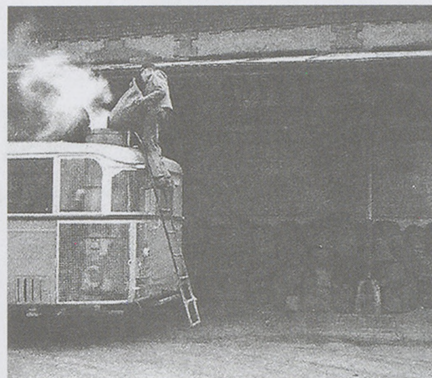
Das Holz wird von oben hineingeschüttet. Unten wird die Asche und Schlacke wie bei einem Ofen herausgescharrt. (Foto: zvg)
