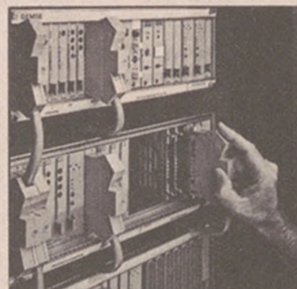
⑦ Fernwirktechnik Installation de télé- commande ALBIS tc 3-20
