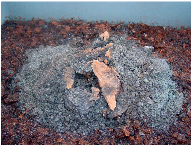
Abb. 95. Experimente. Nach Frosteinwirkung sind die nicht gebrannten Lehmfragmente an der Oberfläche in kleine Stücke zersprungen, während die gebrannten Fragmente relativ formstabil geblieben sind.
