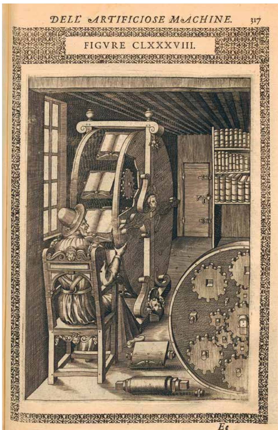
Drehbares Leserad, Illustration aus: Agostino Ramelli, Le diverse et artificiose machine . Paris 1588.
