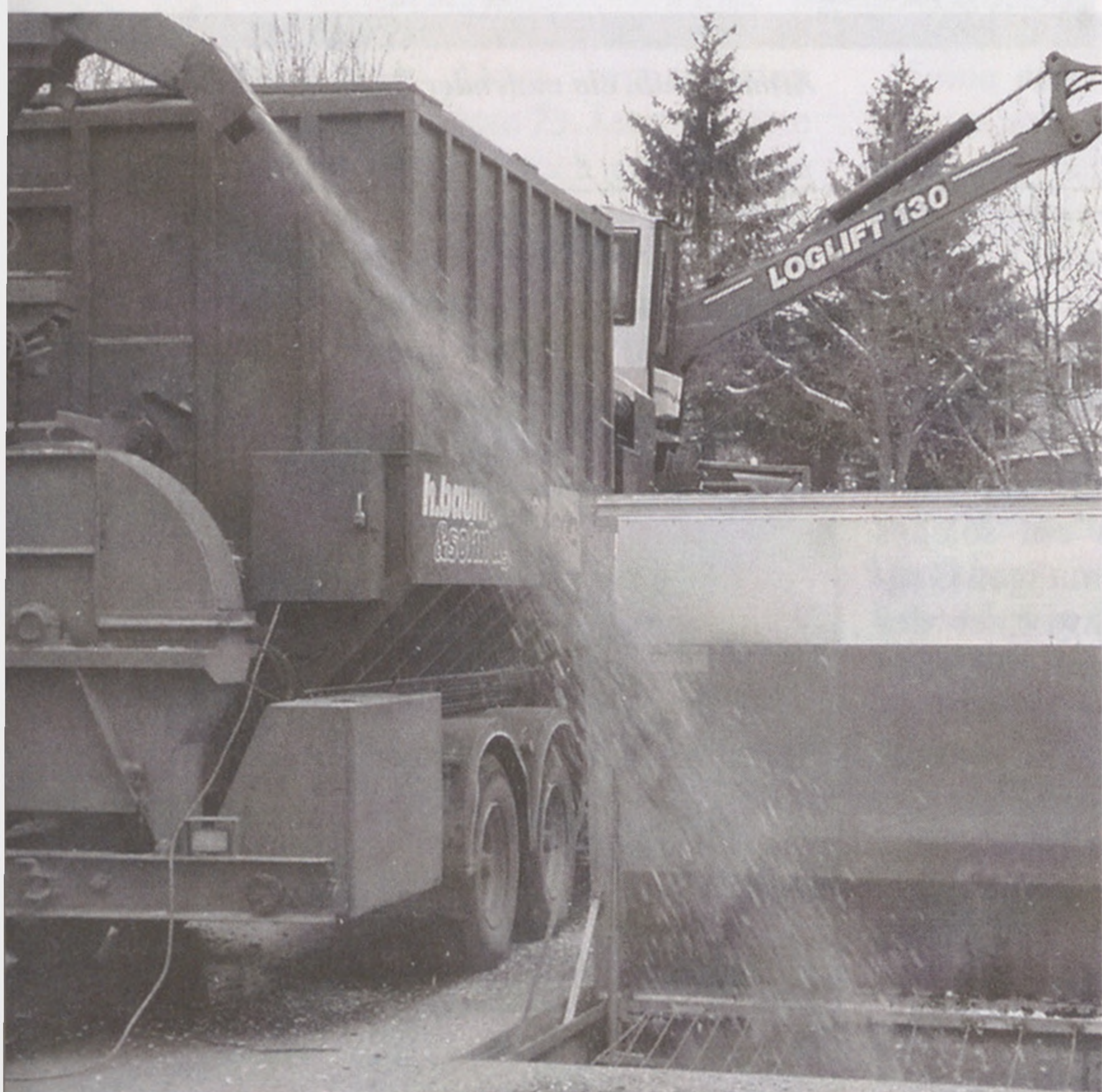
Vorne ergreift das Holzhackauto ganze Baumstämme auf einmal, hinten kommen sie als Schnitzel heraus. (Foto: go)
