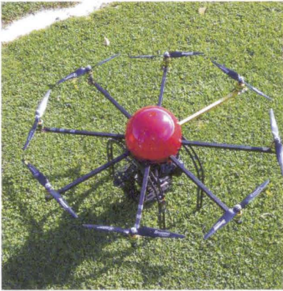
Der Oktokopter auf Grund und in der Luft, bestückt mit einer Full HD Videokamera (Bild: Doris Bruno)
