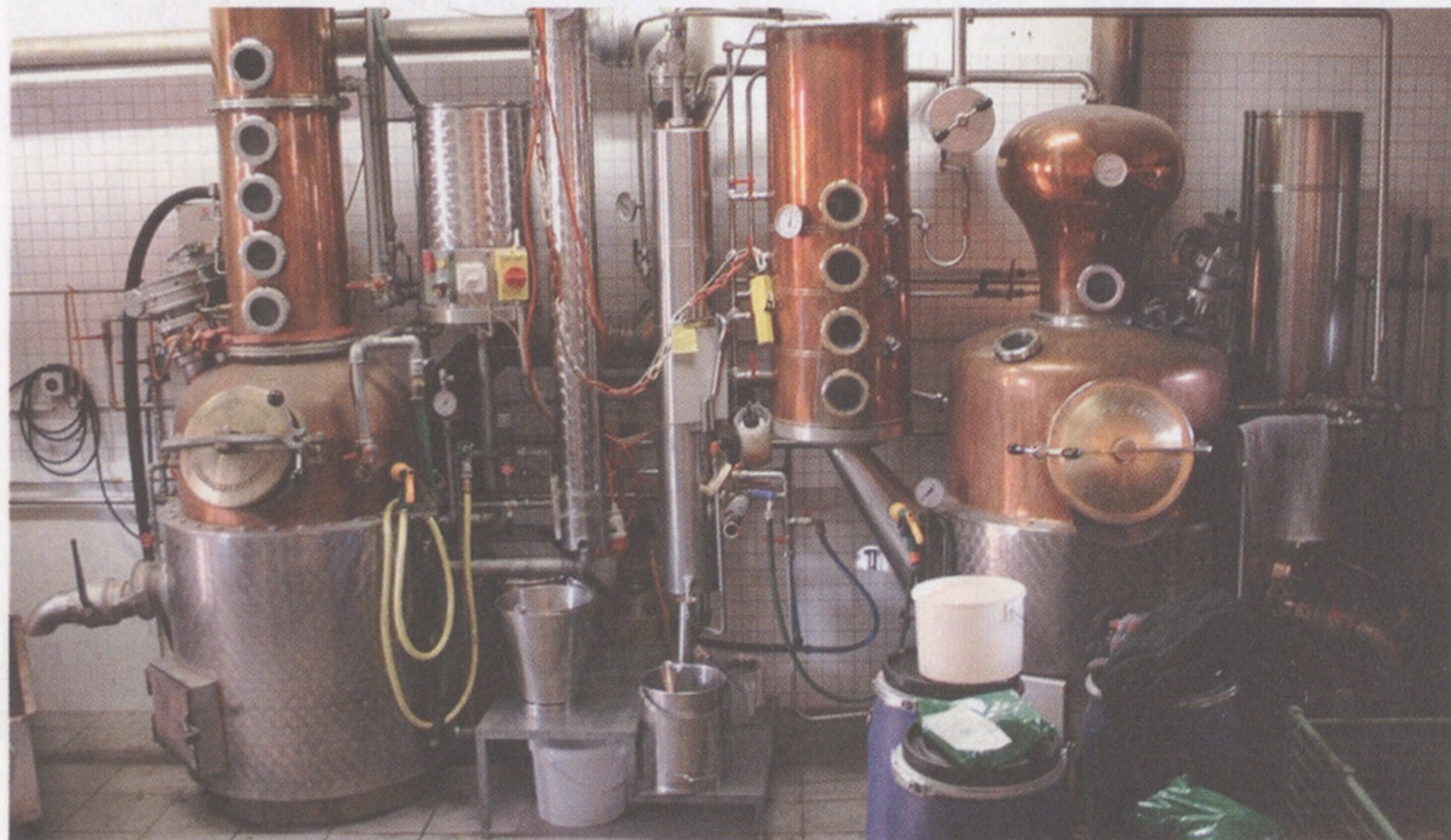
Ein Blick in die Schnapsbrennerei von Felix Kunz. In der Mitte am Boden der Stahlkessel, der das gebrannte Destillat auffängt.
