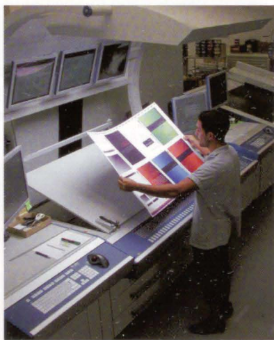
Dank modernster Technologie und leistungsstarken Präzisions-Druckmaschinen können heute pro Stunde bis zu 18'000 Papierbogen im Format 70 x 100 cm vierfarbig bedruckt werden. Jeder Bogen wird einzeln fotografiert und ausgemessen. Dieser digitale Datenabgleich garantiert eine gleichbleibende Spitzenqualität. Hier der Arbeitsplatz des Drucktechnologen für eine dieser Maschinen in der Comprinta AG in Schwerzenbach.
