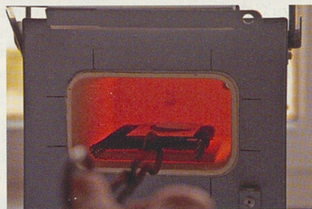
... und im Ofen bei ca. 800° C gesintert.
