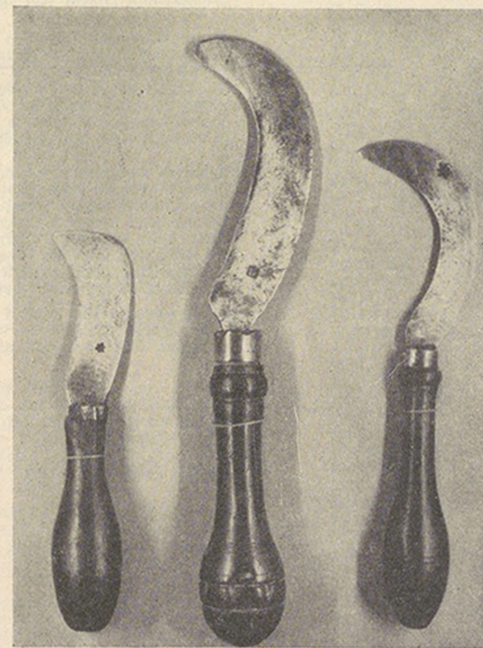
Rebmesser: links zum Lösen; in der Mitte zum Schneiden und rechts zum Wümmen
